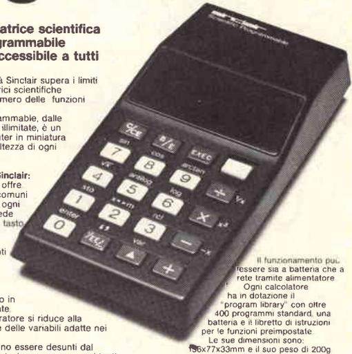
Il funzionamento può essere sia a batteria che a rete tramite alimentatore. Ogni calcolatore ha in dotazione il "program library" con oltre 400 programmi standard, una batteria e il libretto di istruzioni per le funzioni preimpostate. Le sue dimensioni sono: 196x77x33mm e il suo peso di 200g.
